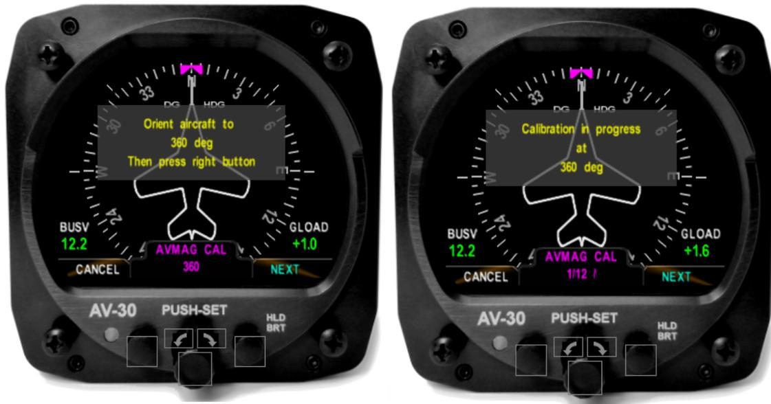
Figure 54: AVMAG CAL In-Progress
