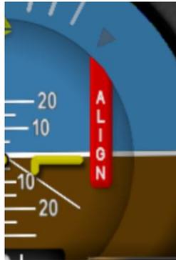
*Figure 40 - Aligning Annunciator*
